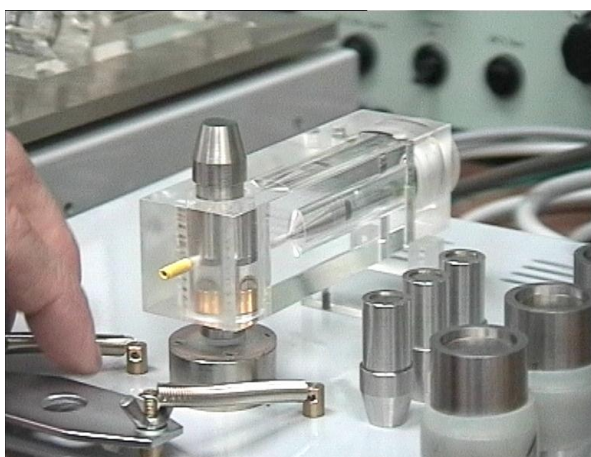
Obr. 7 Sada etalónových zaslepovacích zátok Obr. 8 Časť zariadenia pod Add.. B (bod 1. a 2.)
