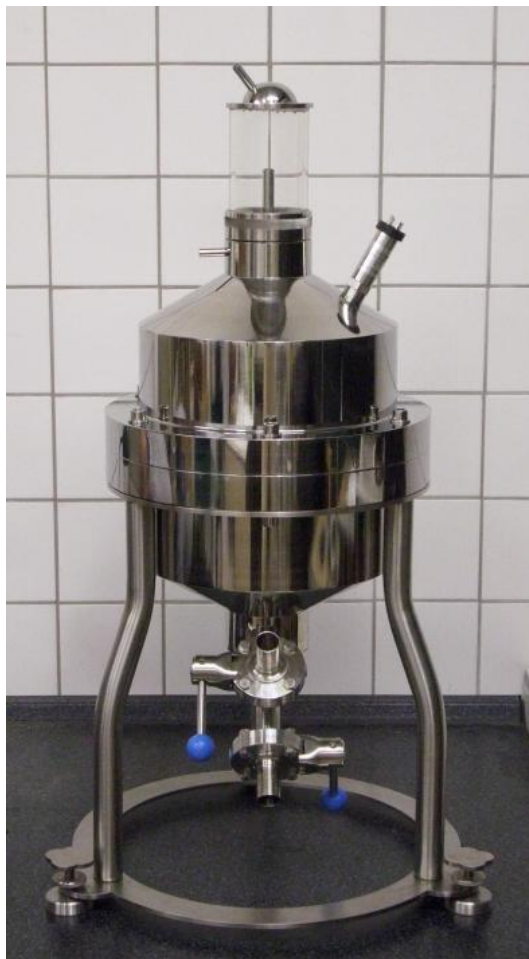
OBRÁZOK 5 Nová etalónová nádoba – etalón statického objemu s nominálnym objemom V_n = 20 \text{ dm}^3 . Rozšírená neistota objemu nádoby, U \leq \pm 0,002 \text{ dm}^3 (pre k = 2 ), ( U \leq \pm 0,01 \% (pre k = 2 ))
