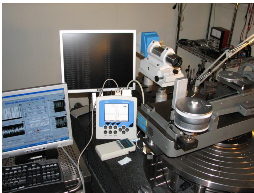
ETALÓNOVÉ ZARIADENIE SAG TA-48 JE PRIPRAVENÉ NA OPÄTOVNÉ ZARADENIE DO NE ROVINNÉHO UHLA
